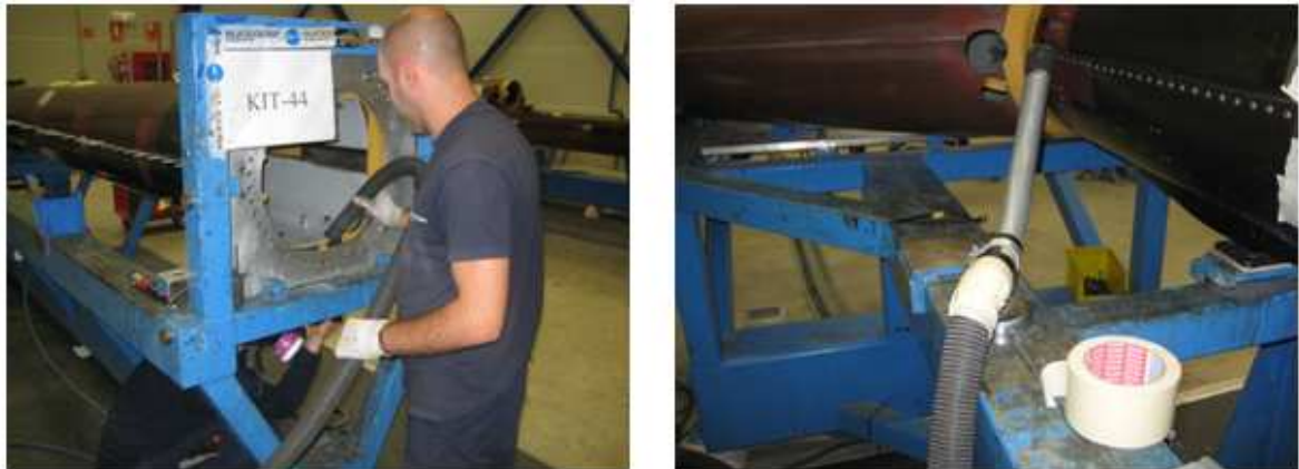
Figura 22 – Furação no posto 3 – Fonte: Tomadas pelo autor.
